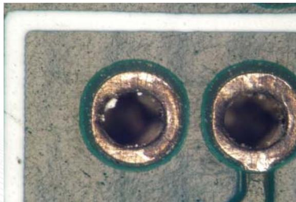
穴の側面(電子回路のくぼみ)の付着物
